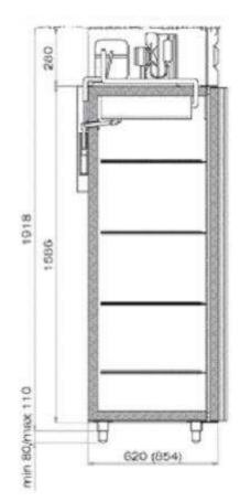
POLAIR CV позволяют хранить продукты в трех температурных диапазонах: при отрицательных температурах (до  $-5^{\circ}$ C), при положительных температурах (до  $+5^{\circ}$ C) и около  $0^{\circ}$ C. Модели CV 105-G и CV 107-G выполнены из нержавеющей стали марки AISI 304 и предназначены для работы в помещениях с жестких санитарными требованиями.
