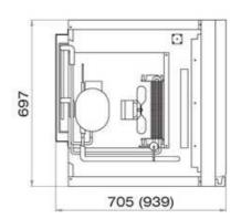
Корпус герметичный цельнозаливной по лицензии "Surfrigo" (Италия), изготавливается из оцинкованной листовой стали с полимерным покрытием и защитной пленкой (Финляндия), комплектуется компрессорами «Danfoss» (Дания) и «L'Unite Hermetique» (Франция),электронные блоки управления и фильтры-осушители «Danfoss» (Дания), пенополиуретан «BASF» (Германия). Вся продукция на заводе проходит 100% контроль качества
